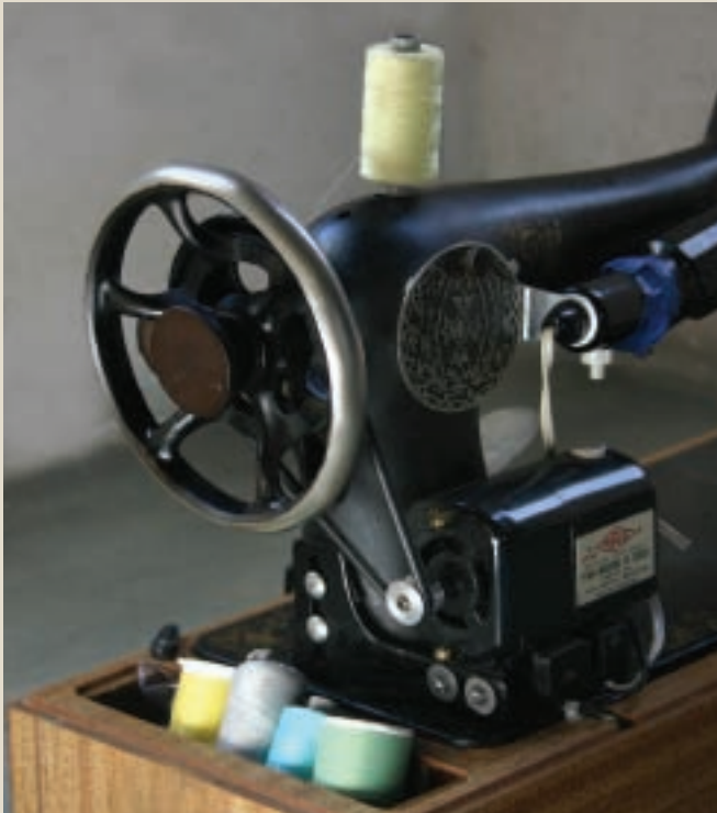
Las poleas transmiten movimientos de rotación.
