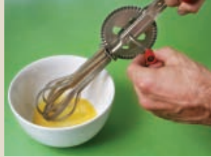
Batido mecanizado. Mediante un mecanismo de engranajes se transmite el movimiento generado a partir de la manivela.
